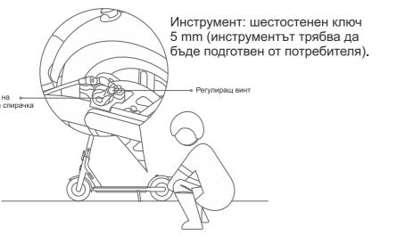
Инструмент: шестостенен ключ 5 mm (инструментът трябва да бъде подгответ от потребителя).
